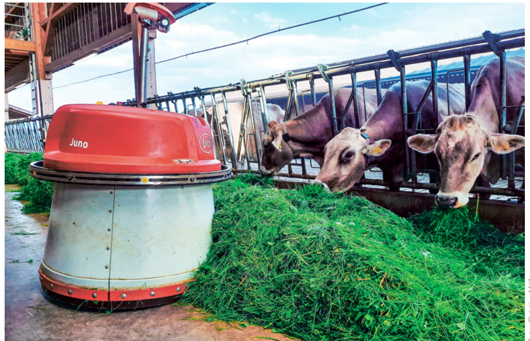
Fütterung von Milchkühen mit Hilfe eines automatischen Futterschiebers.
