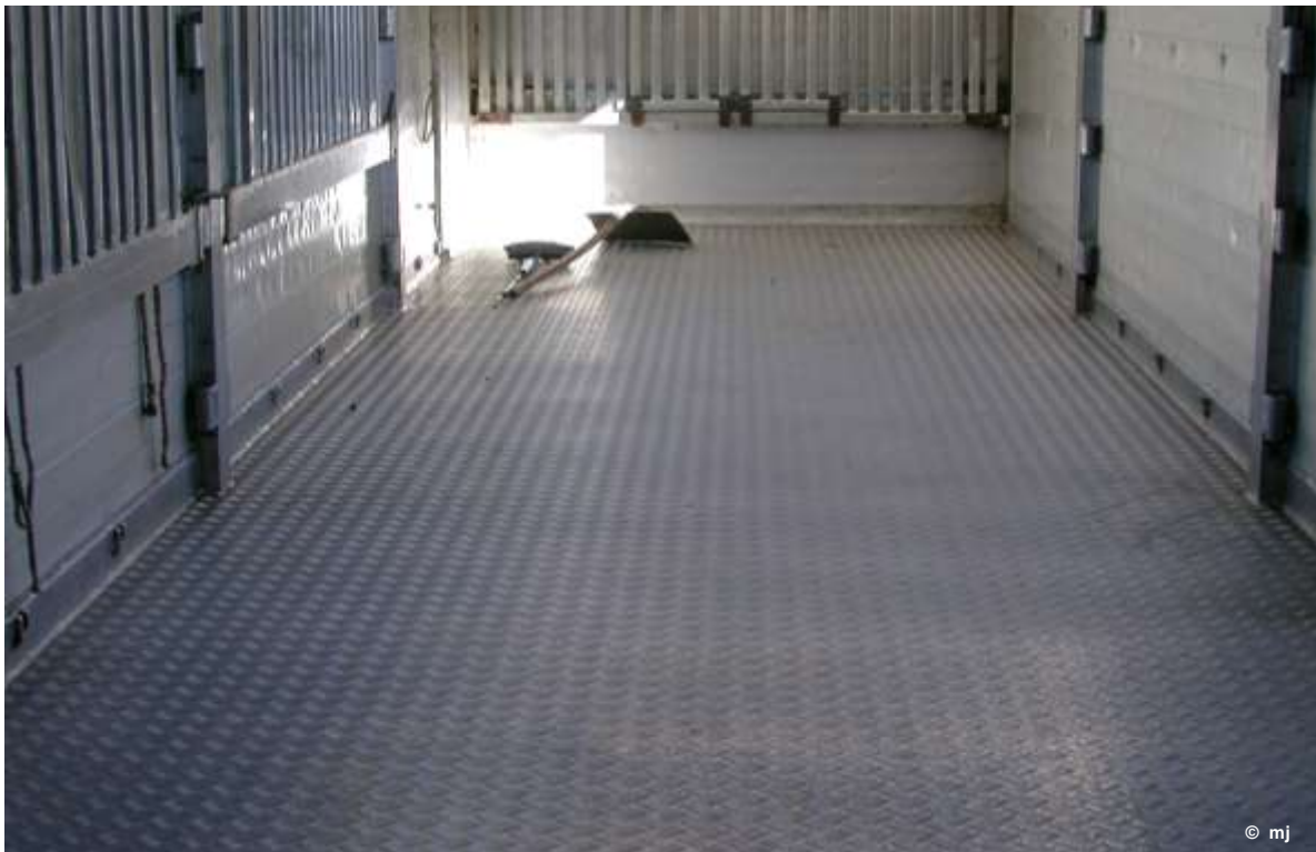
Dichter, wasserundurchlässiger Boden mit spritzwasserdichten Wänden.
