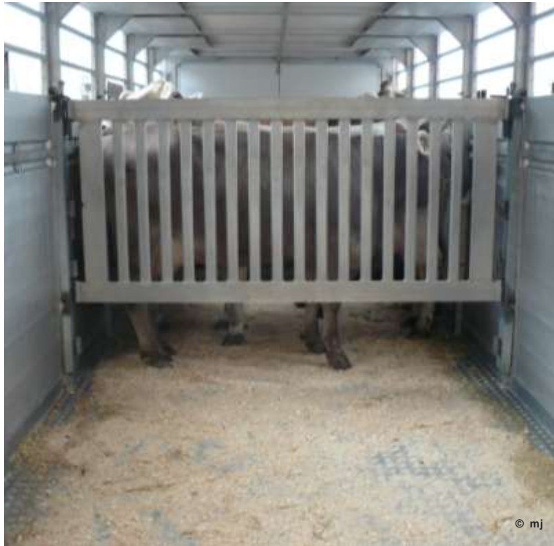
Korrekte Abtrennung zur Einhaltung der Transportfläche.
